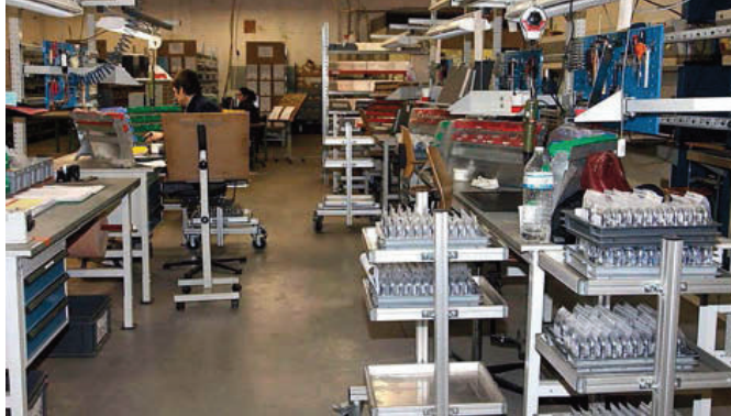
Op deze werkruimte werd een Kaizen event uitgevoerd, waardoor het aantal werkposten gereduceerd werd van acht naar vier, de nodige werkoppervlakte gehalveerd werd en de waarde van de voorraad met ongeveer 15.000 euro werd gereduceerd. Tevens werd de flow van de goederen aangepakt, inkomend aan de achterkant bij het orderbord en vooraan uitgaand, klaar voor verzending
