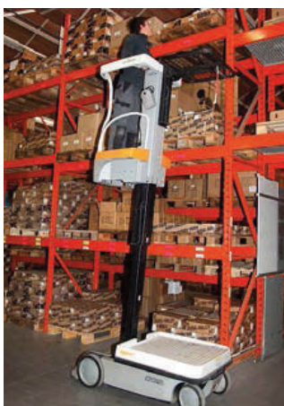
Het picken van de orders in de hoogte gebeurt met een orderpicker, wat een grote productiviteitswinst betekent
