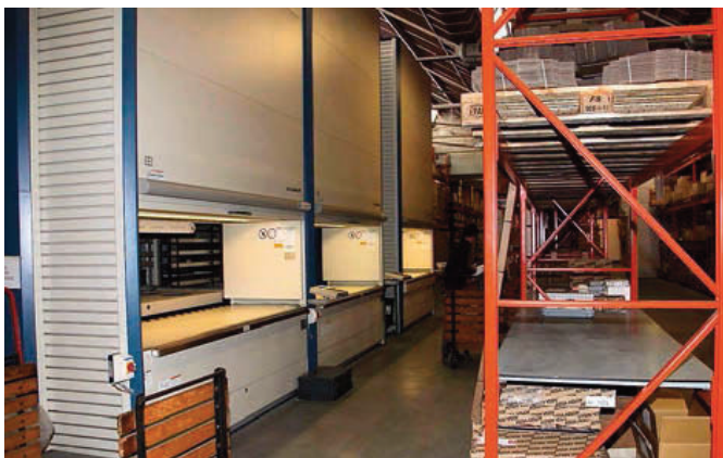
De opslag gebeurt in stocktorens, rechtstreeks verbonden met het ERP-systeem. Het intypen van ordernummers en dergelijke hoeft niet meer te gebeuren omdat alles via barcodes verloopt
